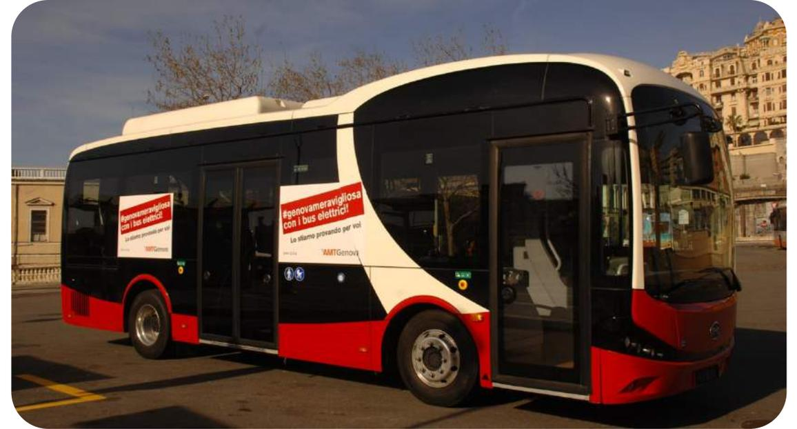
Aria condizionata o riscaldamento possono ridurre l'autonomia anche del 25% e oltre ... I consumi dichiarati per vetture da 12 metri si attestano tra gli **1,2 kWh/km e 1,8 kWh/km** (senza considerare riscaldamento o aria condizionata).
